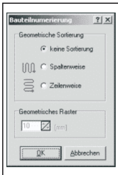
Figuur 7: Het automatisch hernummeren van alle onderdelen in een logische volgorde.
