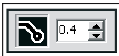
Figuur 14: In dit venster definieert u de afstand tussen uw printsporen en de automatische massa.
