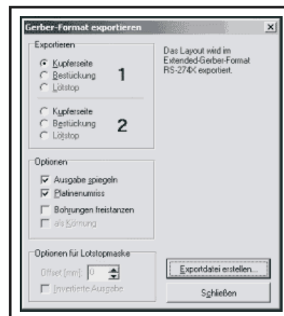
Figuur 21: Export van uw printontwerp naar een Gerberbestand dat door alle printfabrikanten kan worden verwerkt.
