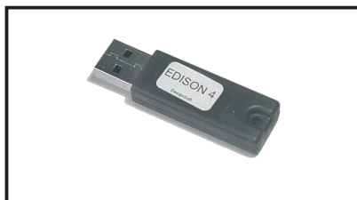
Figuur 14: Met deze kleine USB-dongle wordt het programma beveiligd tegen kopiëren.
