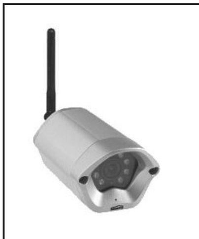
Figuur 6: De infrarood werkende nachtzicht camera van het GIGACAM 4™ systeem.
