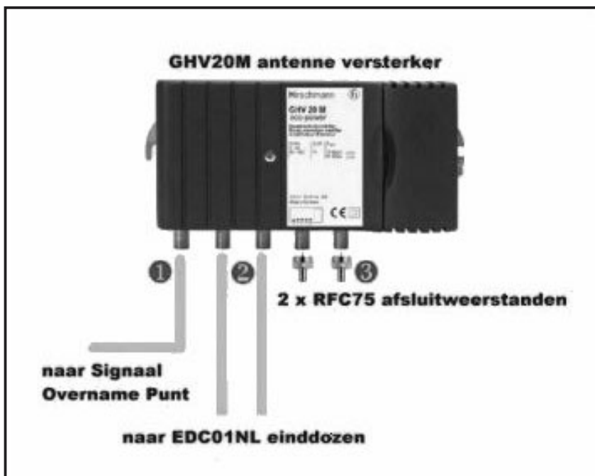
Figuur 21: Het afsluiten van twee ongebruikte uitgangen van de antenneversterker GHV20M met behulp van RFC75 afsluitweerstandjes.
